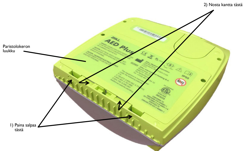
Kuva 7: Paristolokeron huukun irrottaminen
